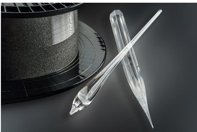
**Abb. 2** Achteckige Faserpreform, Glaspfropfen vom Beginn des Faserziehprozesses und aktive Laserfaser auf Trägerrolle.
