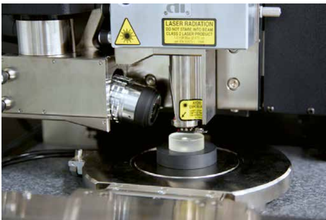
Figure 8: DI Nanoscope 3100 AFM®
