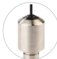
Radenfräser für Submikrolinsen (Außendurchmesser 0,5 mm)
