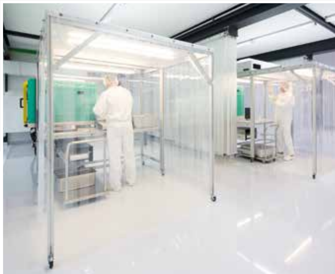
Reinraumzelle „Soft wall“ in der Spritzgussfertigung
